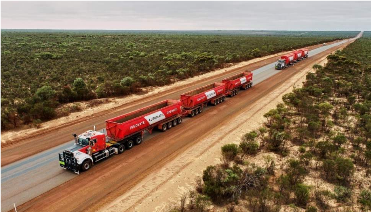
ŞEKİL 3.20. Lastik Tekerlekli Tren (Karayolu Treni) Örneği
