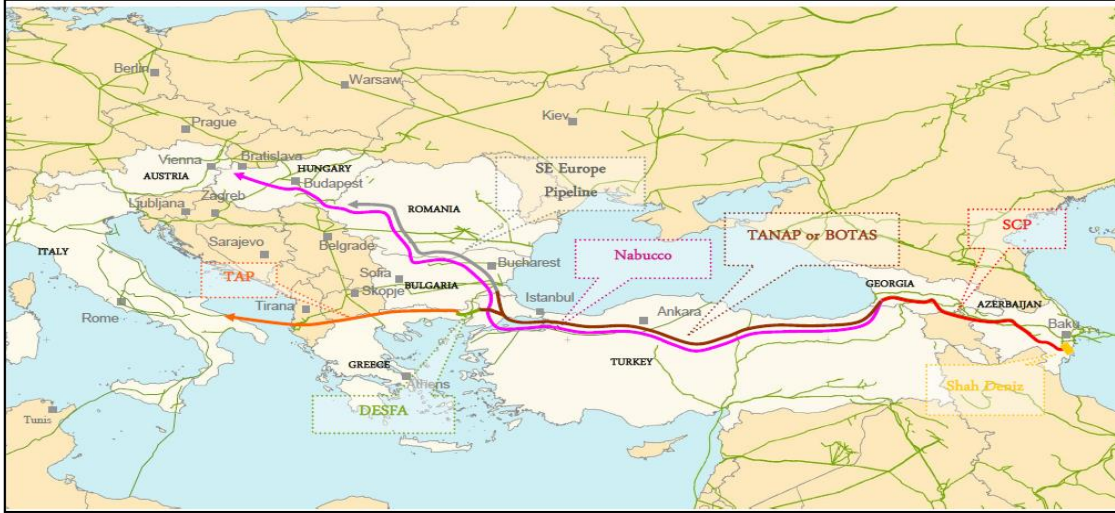
Şekil 2.12 Güney Koridoru Boru Hatları
